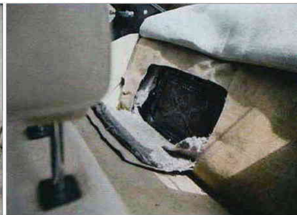
Bougies vervangen? Met de knop vouwt de achterbank naar voren. Onder de bekleding zit een luik naar de motor.
