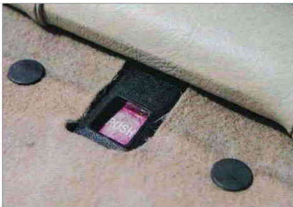
Bougies vervangen? Met de knop vouwt de achterbank naar voren. Onder de bekleding zit een luik naar de motor.
