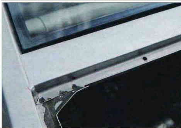
Plooijs in de rand van de motorkop veroorzaken roest. De goedkope oplossing is een dik plakkertje.
