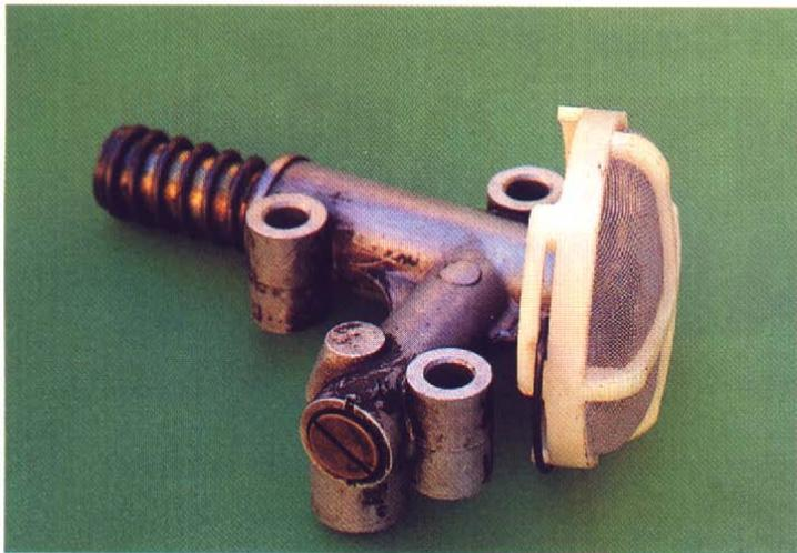
Sopra a sinistra, una particolarità di questo motore è costituita dall'adozione di una semplicissima pompa dell'olio a pistoncino, azionata da un eccentrico posto sull'albero primario del cambio.
