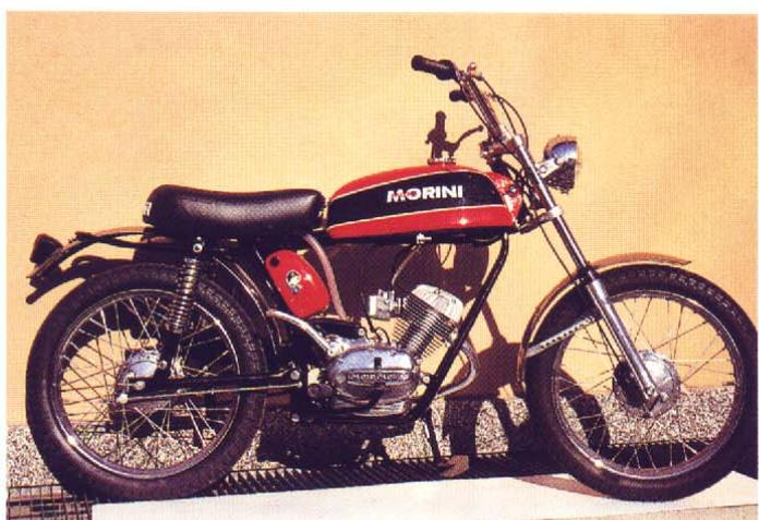
Nelle foto, due Super Scrambler. Questo modello, con il quale ha fatto la sua comparsa il nuovo telaio a doppia culla continua, era dotato di forcella telescopica idraulica a canne scoperte.
