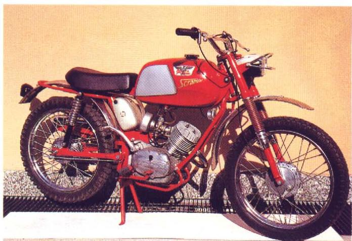
Due esemplari di diverse versioni del modello Scrambler, con il serbatoio di notevole capacità e con il caratteristico tubo di scarico rialzato.
